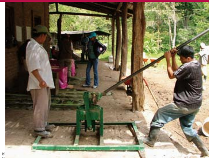
Au Nicaragua, on apprend à se servir de la presse mécanique pour compacter les briques nécessaires à la construction d'un écotour.
